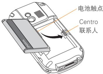
**重要事项** 请使用 Centro 附带的电池。不要在 Centro 中使用其它型号的 Centro 中的电池。同样，也不要将 Centro 电池用在其它型号的 Centro 中。使用为其它型号的 Centro 设计的电池会损坏您的 Centro。有关兼容电池的信息，请参见[更换电池](#)。
