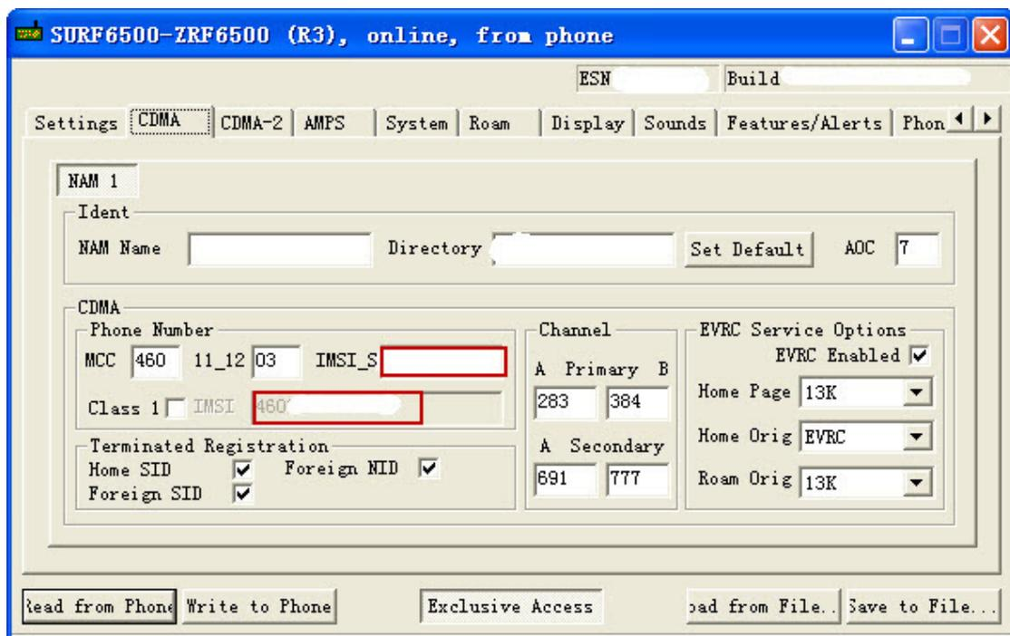
8、选择“System”界面，双击红框中的位置，其中 SID 填入你所在城市的 SID(可以从“国家代码.txt”中查询到)；NID 填入: 65535；（我试过将 NID 填为 0，出现的情况是用 755P 拨打电话时没有铃声，其它正常）
