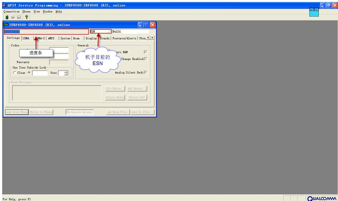
5、读取完手机信息后，会弹出一个框，输入步骤三第 11 点中的 6 位数字，按“OK”键；
