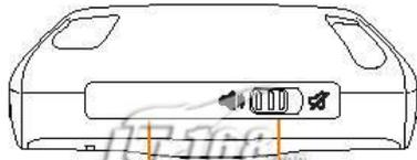
红外线 (IR) 端口 响铃开关
