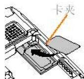
**5** 将 **sim** 卡卡夹滑入智能手机中的插槽。
