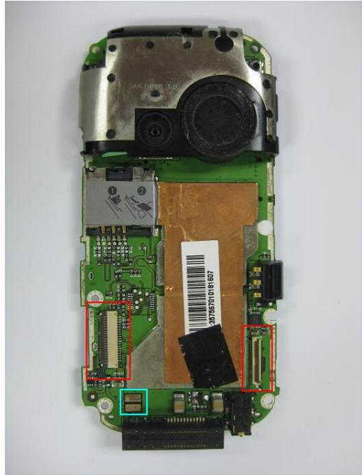
贴了这么大一块导电布，要是我在手机上搞这么大块，非被老板骂死，这么大块导电布得增加多少成本哦。。其实贴导电布的目的主要有两个：一是 ESD 接地，二是保证手机射频性能。屏的数据线因为要不停的刷新，常常是手机主要的干扰源。这块导电布正是包住了屏的 FPC，同时保证了屏和键盘板部分的 ESD 性能。红色方框分别是屏和键盘的 ZIF 连接器。蓝色方框镀金 PAD 是马达的触点。看看这个 PAD 厚度，就知道 Palm 对产品质量的严格程度，这是镀金的工艺，比起一般手机上的化金工艺，成本会高很多。
